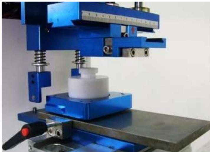
步驟三：將鋼板往前推到底，把塑膠把手(A 處)鎖緊，再將墨杯罩往前推到底(如下圖)。
