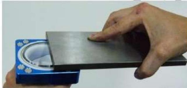
步驟三：將鋼板平推至覆蓋整個墨杯組合(如下圖)。
