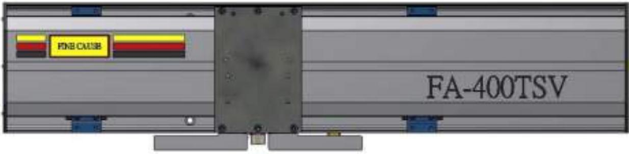
帶動刮膠座左右位移，其左右定位位置與移動速度由人機操作控制。滑台座下方為左右極限開關與近原點開關的感應片。
