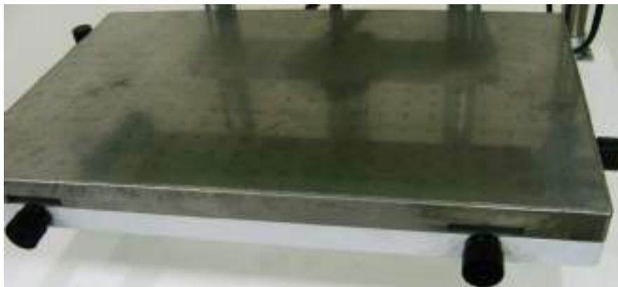
當被印物為較薄之物體時，如：塑膠薄片：壓克力片等，因無法使用固定座定位，則需使用此真空吸風平台加以定位，以確保印刷位置之精準。再使用吸風之前必先開啟機台右側之搖頭開關，此開關為吸風馬達之開關，其平台之調整方式與T型平台無異。
