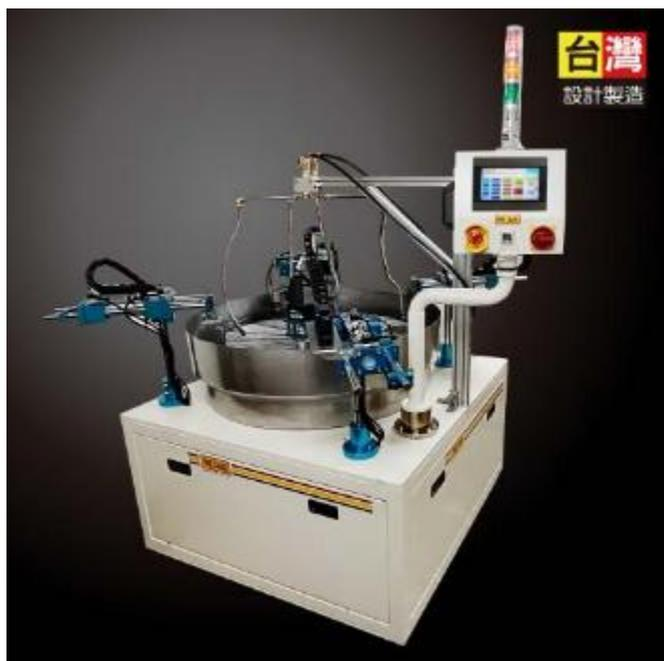
專為中型工件設計，支援多種金屬與非金屬材質的濕式精密研磨與拋光處理。
