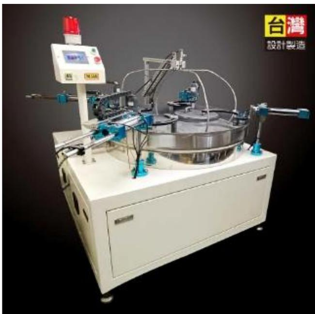
專業濕式研磨機與自動研磨拋光機，最大尺寸達 400×600mm，適用多材質高精度加工，提升表面粗糙度與平坦度。適用金屬、SKD11 鋼板、陶瓷、玻璃...等材料，廣泛應用於精密製造業。
